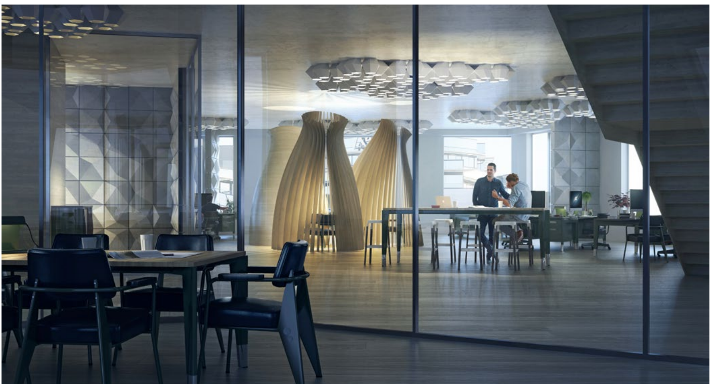
Figur 11: Akustiske elementer i form av «akustisk rur» i himling og «workløker» i oppholdssonen. III.: Snøhetta/MIR
